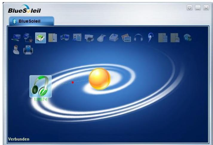
9. Falls Sie das Fenster vom COM-Port nicht sehen konnten, probieren Sie folgendes: Stellen Sie sicher, dass die Bluetooth-Verbindung zu SmartPick aufgebaut ist (grüne gestrichelte Linie zwischen SmartPick-Symbol und Sonnensymbol). Rechtsklicken Sie auf das SmartPick-Symbol und wählen Sie **Eigenschaften**. Ein Fenster erscheint, in dem Sie neben anderen Informationen auch den benutzten COM-Port finden. Klicken Sie **OK**, um das Fenster wieder zu schließen.
