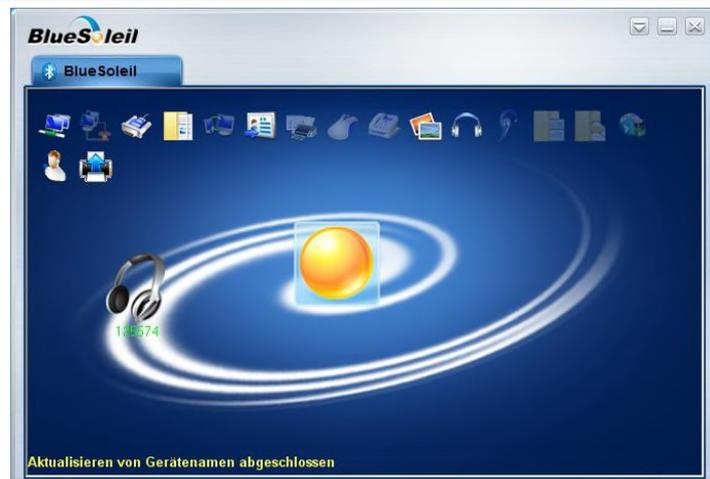
7. Doppelklicken Sie auf das Symbol des seriellen Schnittstellendienstes (weißer Pfeil). Die Verbindung wird aufgebaut, es erscheint für kurze Zeit ein Fenster, auf welchem die Nummer des COM-Ports angezeigt wird.
